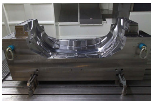
Moule à injection d'un pare-chocs, fabriqué dans l'usine Volkswagen de Braunschweig
