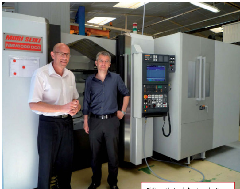
Philippe Martaud, directeur du site Soprema, et Ludovic Couillaud, président du groupe ARM, devant la dernière acquisition de la filiale : un centre d'usinage 5 axes Mori Seiki doté d'un palettiseur à 6 palettes.
