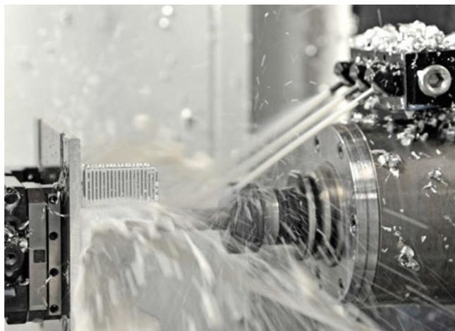
Usinage d'une ferrure aéronautique. L'ébauche 3D ne laisse pas de place pour le parcours d'outil hors matière. La fonction "Ebauche résiduelle optimisée" d'*hyperMILL®* oriente en automatique la broche pour aller chercher le moindre brut restant avec des outils courts.
