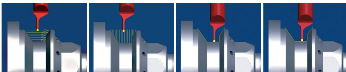
加工の難しい素材に対応する傾斜角度を使った軸方向の溝加工
