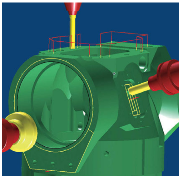
移動、傾斜させたワークプレーン
