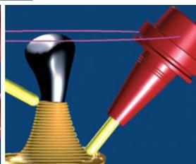
L'asse dell' utensile si orienta sempre tramite la curva guida
