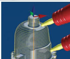
Orientamento radiale dello utensile rispetto all'asse Z
