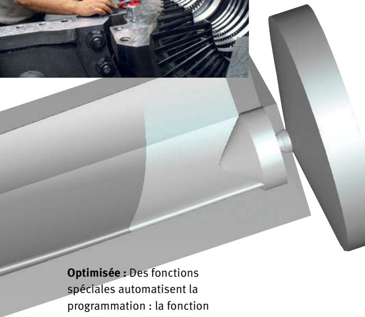
**Optimisée :** Des fonctions spéciales automatisent la programmation : la fonction bille ou « rolling-ball » fraise les rayons, et la fonction de positionnement au mieux, ou « best-fit », détermine automatiquement la meilleure position de départ pour la finition ou la correction automatique de l'angle guide pour la prévention des collisions.
