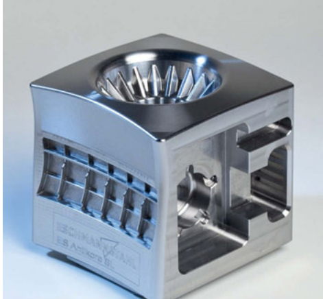
hyperCAD-S®とhyperMILL®による加工例
