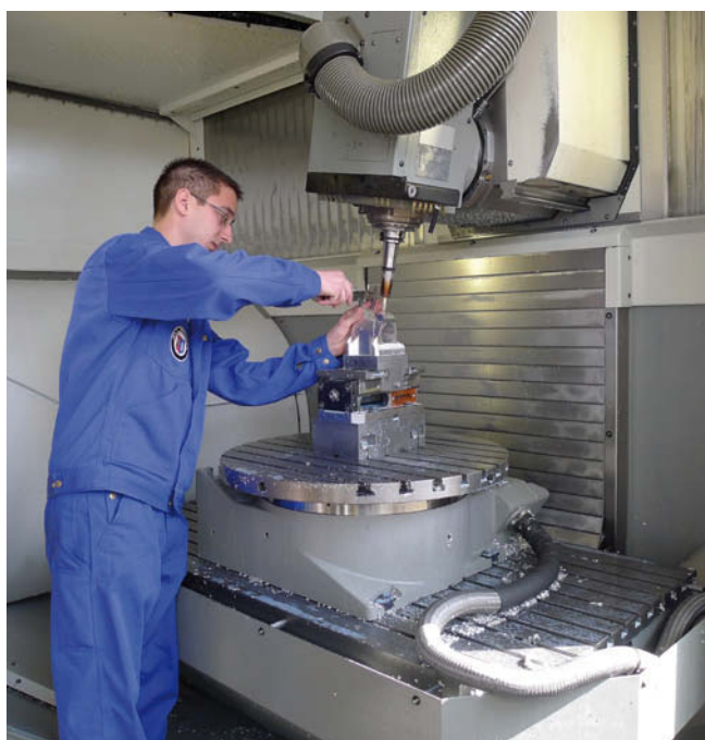
DMG社製の5軸マシニングセンタで加工されるストラットサスペンションのクランプ
