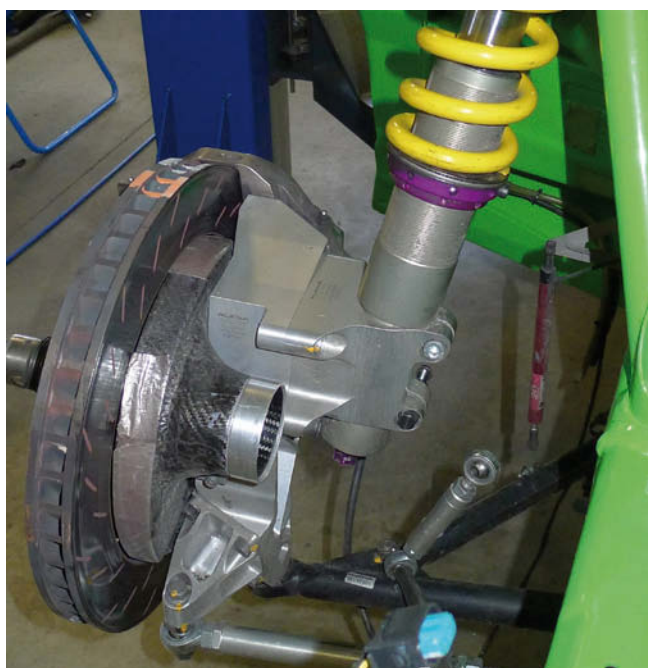
BMW ALPINA B6 GT3 に装備されたストラットサスペンションのクランプ
